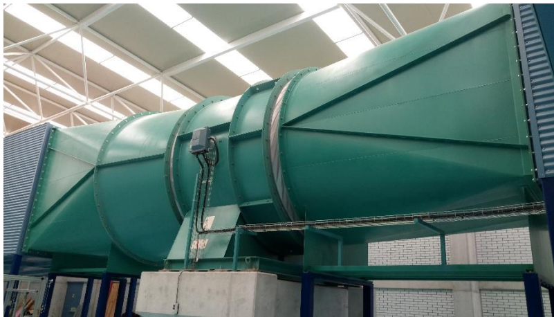
Figura 3.1 Vista exterior del ventilador de flujo axial del túnel de viento del IINGEN
