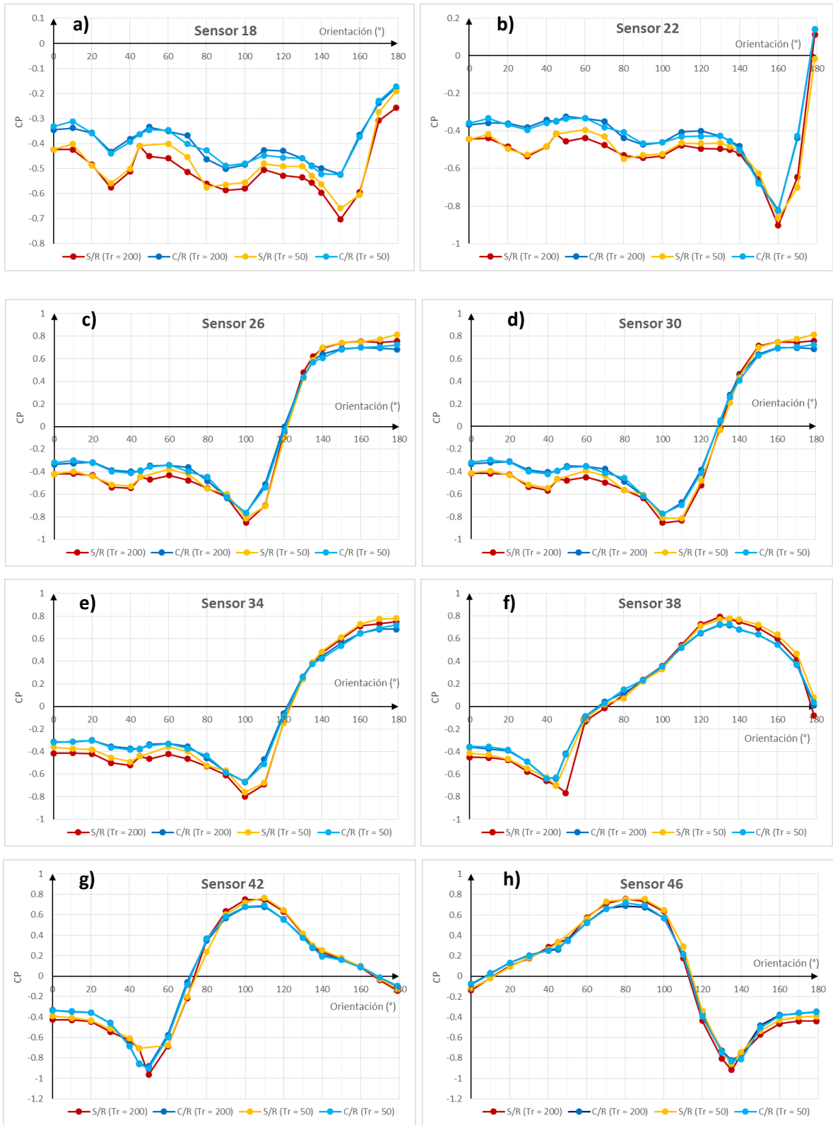
Figura 4.2 Relación de coeficientes presiones con respecto al ángulo de incidencia. a) Sensor 18, b) Sensor 22, c) Sensor 26, d) Sensor 30, e) Sensor 34, f) Sensor 38, g) Sensor 42, h) Sensor 46
