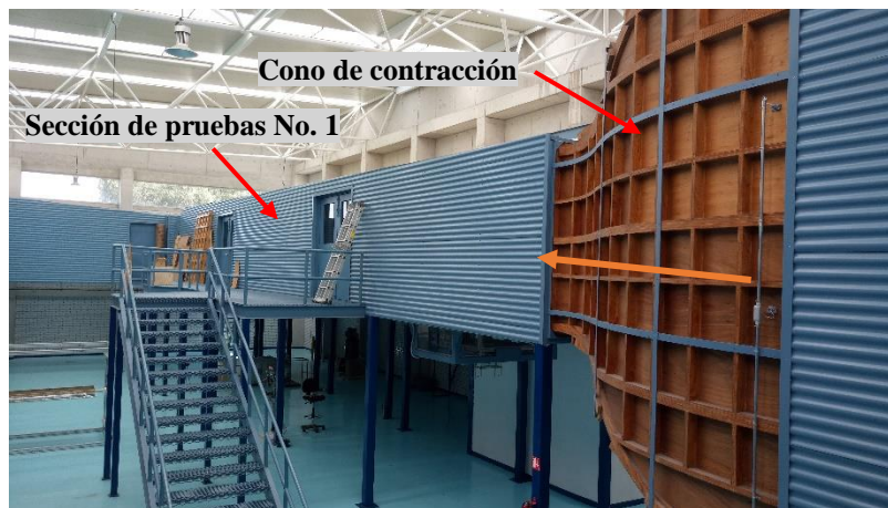
Figura 3.2 Vista exterior del cono de contracción y zona de pruebas No.1
