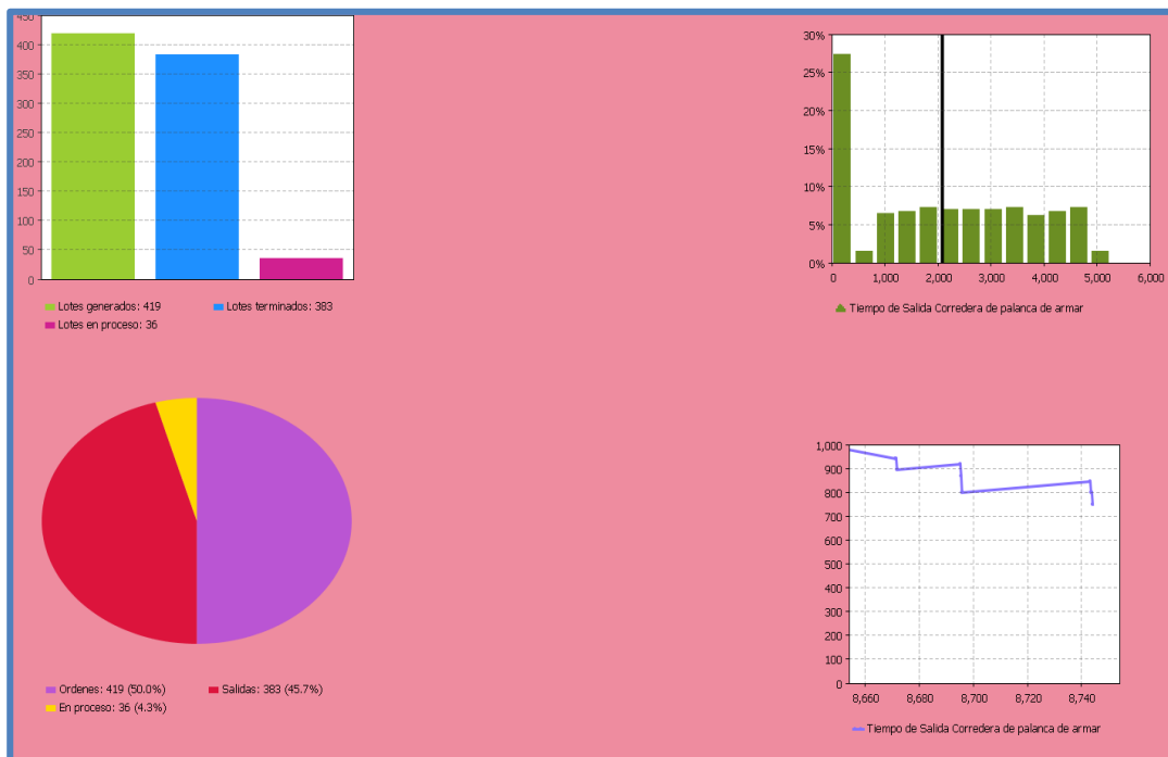
Fig. 43.- Gráficos generados a partir del modelo de simulación propuesto del proceso de producción para la pieza CPAR. Fuente: Elaboración propia (2018).
