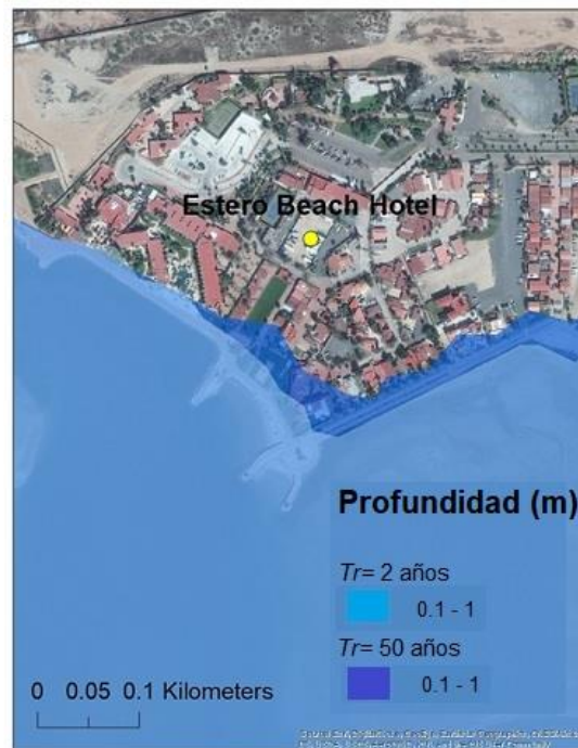
Figura 42. Mancha de inundación para la zona del hotel Estero Beach para el Tr= 50 años. La mancha de inundación se extiende tierra adentro con profundidades entre 0.2 y 0.6 m, siendo más crítico que para el Tr= 2 años.
