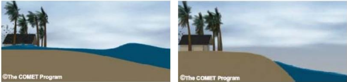
Figura 9. Marea meteorológica según la pendiente de la plataforma continental. Con una pendiente suave, la marejada tiene mayor efecto sobre la costa (izquierda) que cuando se tiene una pendiente abrupta (derecha), en donde el agua se ve frenada por la pendiente (Tomado de COMET, sf).
