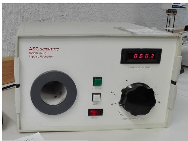
Figura 7.7: Magnetizador de pulsos, con interruptor y perilla de ajuste.
