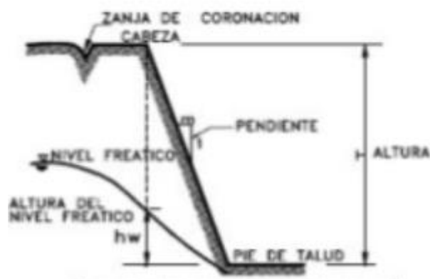
Figura 1.1 Partes de un talud
