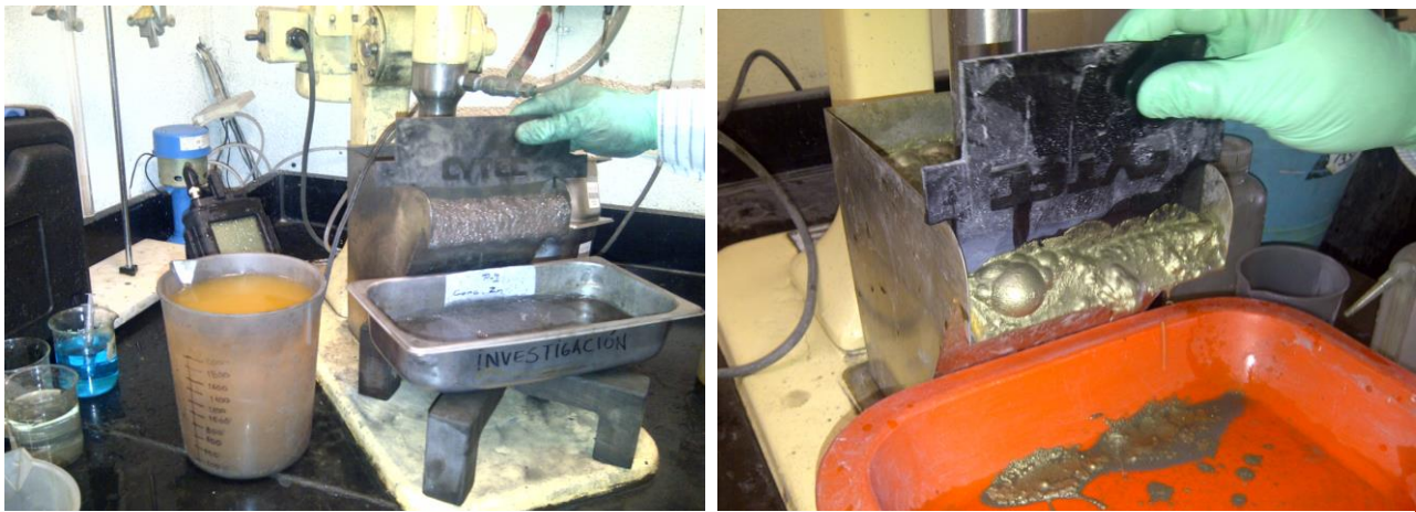
Figura 5.7 – Paleta para remoción de espuma que permite mantener la misma profundidad de arrastre
