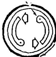
DOBLE ZAPATA GUIADA LA DIRECCION DE ROTACION NO PROVOCA LA AUTOENERGIZACION
