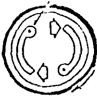
DOBLE ZAPATA LA DIRECCION DE ROTACION PROVOCA AUTOENERGIZACION
