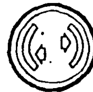
DOBLE ZAPATA GUIADA LA DIRECCION DE ROTACION NO PROVOCA LA AUTOENERGIZACION
