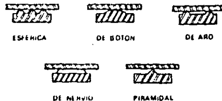
Fig. 11.28 Tipos básicos de soldaduras de resalte
