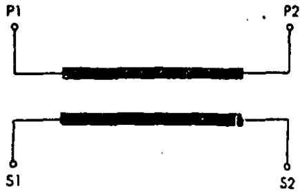
T.P. CON SIMPLE RELACION DE TRANSFORMACION.
