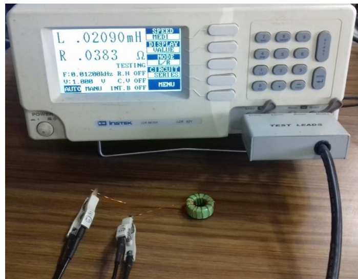
Figura 4.2.4. Resistencia interna del Inductor “ R_L ”.
