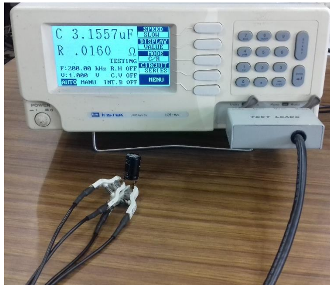
Figura 4.2.3. Resistencia interna del capacitor “ R_{ESR} ”.
