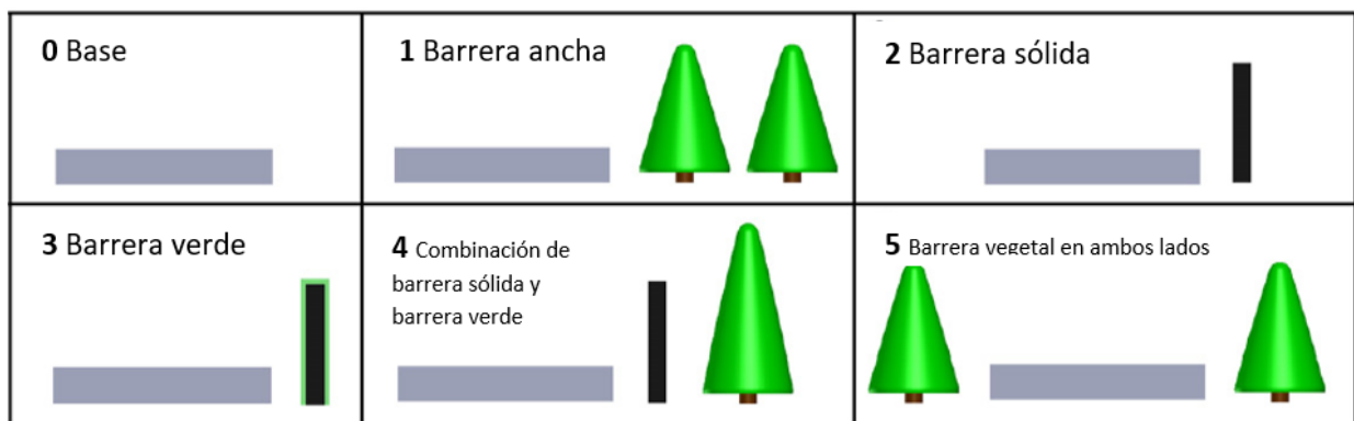
Figura 4.9. Diseño de barreras para mitigar gases contaminantes (Tong et al., 2016)
