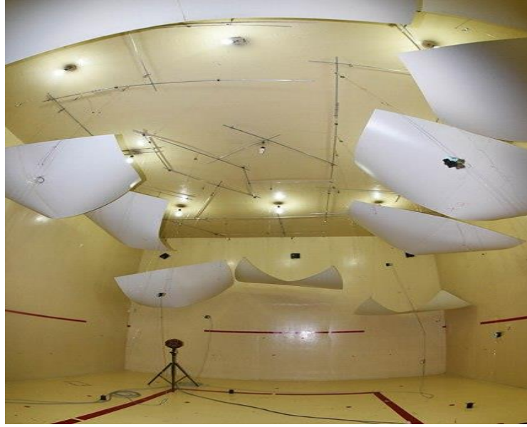
Figura 1.10. Cámara reverberante Fuente: CCADET UNAM
