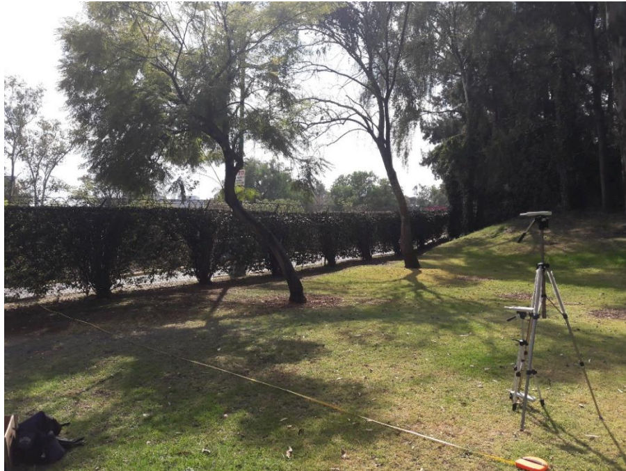
Figura 5.8. Acomodo de sonómetros en Punto 2 a una distancia de 5 m Fuente: elaboración propia
