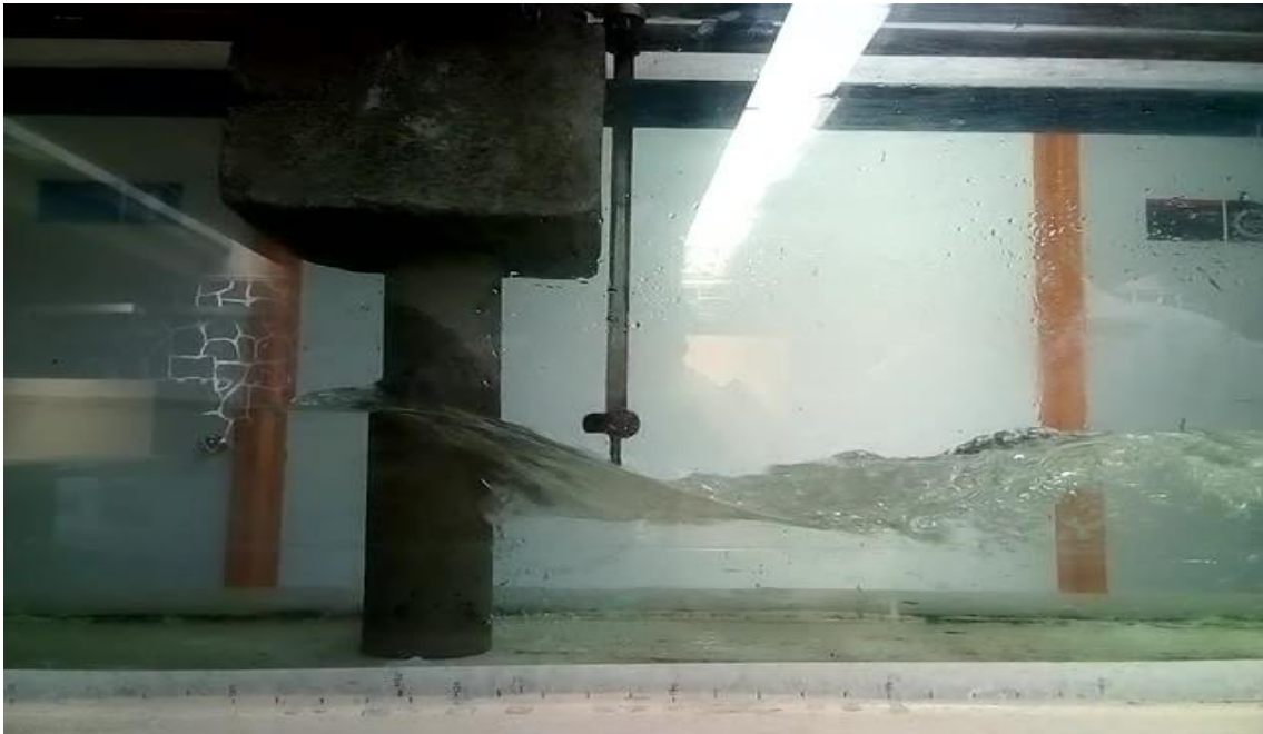
Figura 2. 9 Medición del tirante con pila para Q = 25.75 \text{ lt/s} .
