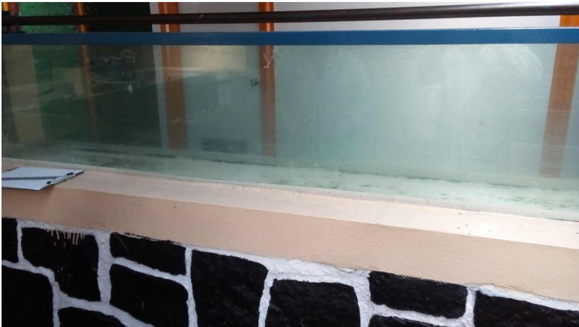
Figura 2. 8 Medición del tirante sin pila para Q = 25.75 lt/s.
