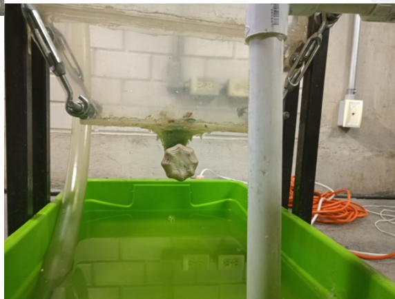
Figura 2.10 Válvula de compuerta colocada al final del sistema
