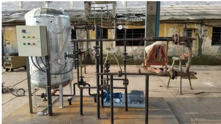
Figura 4-19 Vista frontal del Sistema Emulador Geotérmico.
