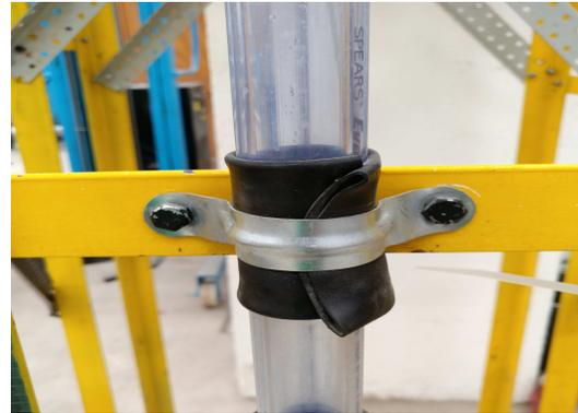
(b) Sujeción de tubería
