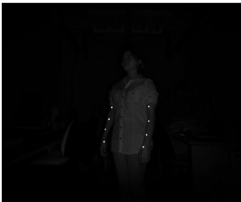
*Figura 41 Imagen IR. Los 8 landmarks se colocaron solamente en la parte frontal de los brazos.*
