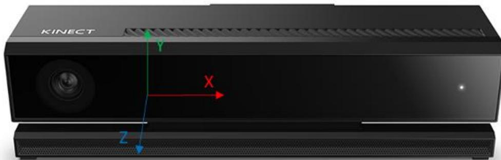
Figura 19 Sistema de referencia del Kinect v2. Imagen tomada de [17].
