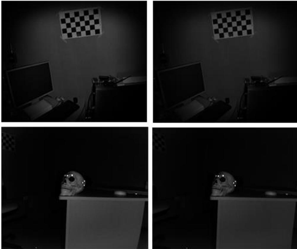
*Figura 9 Imágenes IR. Las imágenes de la izquierda son las que se obtienen inicialmente y tienen distorsión, las imágenes de la derecha se remueve la distorsión.*
