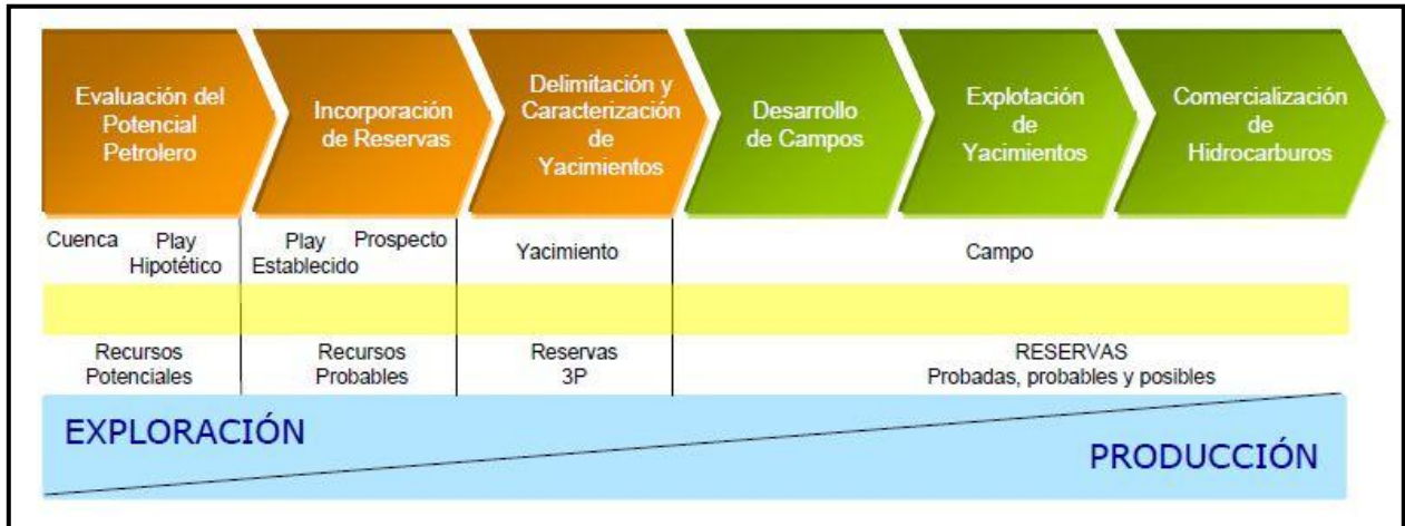
Figura 4.50. Principales etapas del proceso de exploración y producción de un proyecto petrolero (Tomado de PEMEX, 2011).
