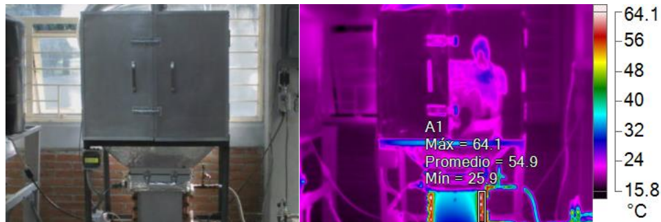
Fig. 58 Captura con cámara termográfica del equipo estabilizado al inicio del proceso de deshidratado
