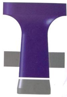
Figura 17. Punzón de geometría cónica. Reduce la fricción entre punzón lámina y matriz. Fuente: The fabricator en español, verano 2016.
