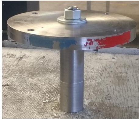
Figura 26. Disco sujeto con ayuda de mandril. Dado el reducido espesor del elemento, el mandril permite que la pieza sea sujeta dejando libre la superficie externa del disco.
