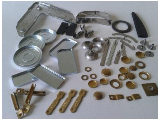
Figura 1. Productos sometidos a distintos tipos de troquelado. Fuente: www.troquelformas.com
