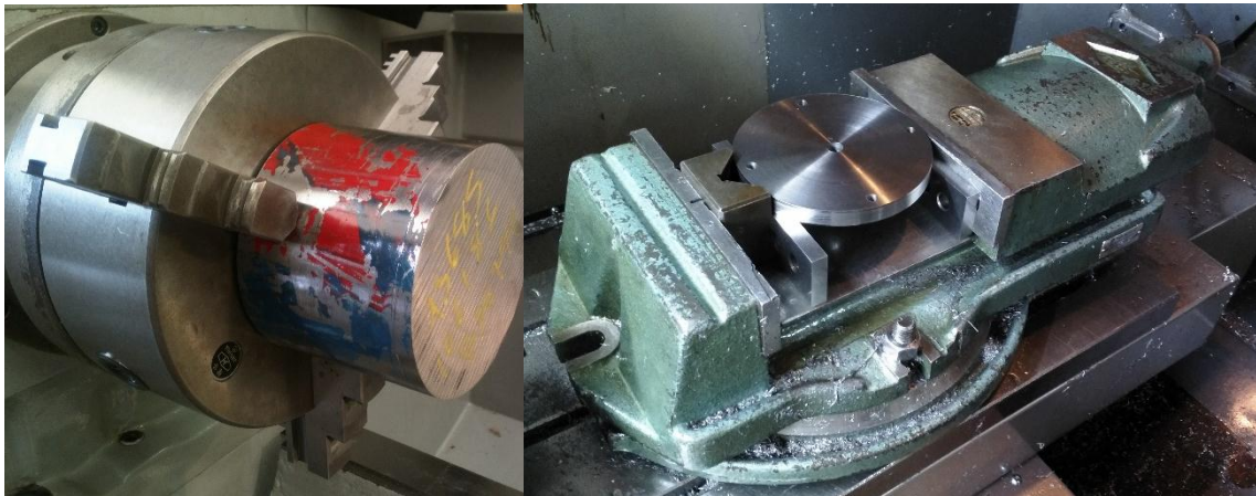
Figura 25. Dos formas distintas de sujetar piezas. A la izquierda, Chuck de tres mordazas o autocentrante para torno, a la derecha, prensa de sujeción para fresadora.
