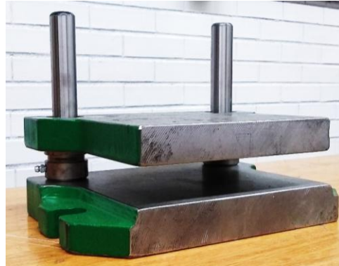
Figura 8. Portatroquel comercial. Este modelo incluye bujes y ejes guía.
