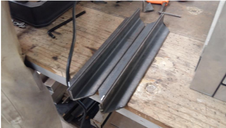
Fig. 122 Tramos de acero cortados a 45[°]
