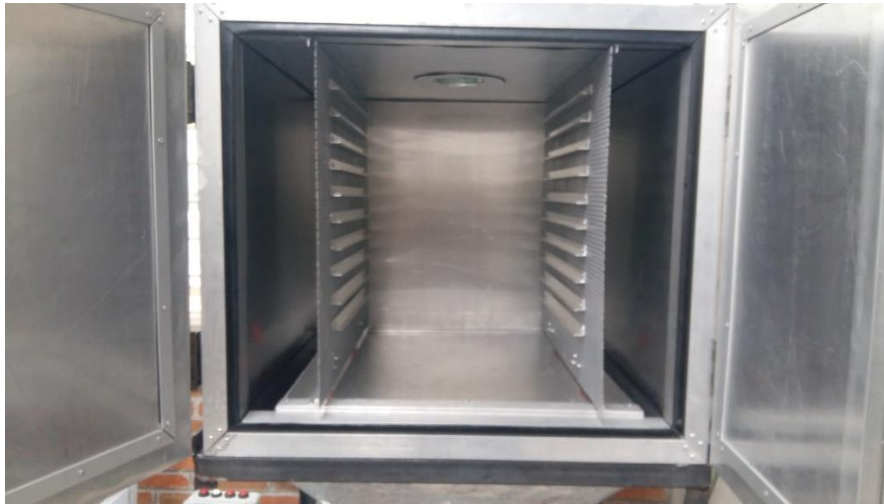
Fig. 113 Espigueros colocados en las láminas perforadas para soportar las charolas
