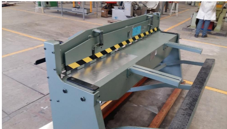
Fig. 114 Guillotina para láminas de metal en el CDM de la Facultad de ingeniería UNAM
