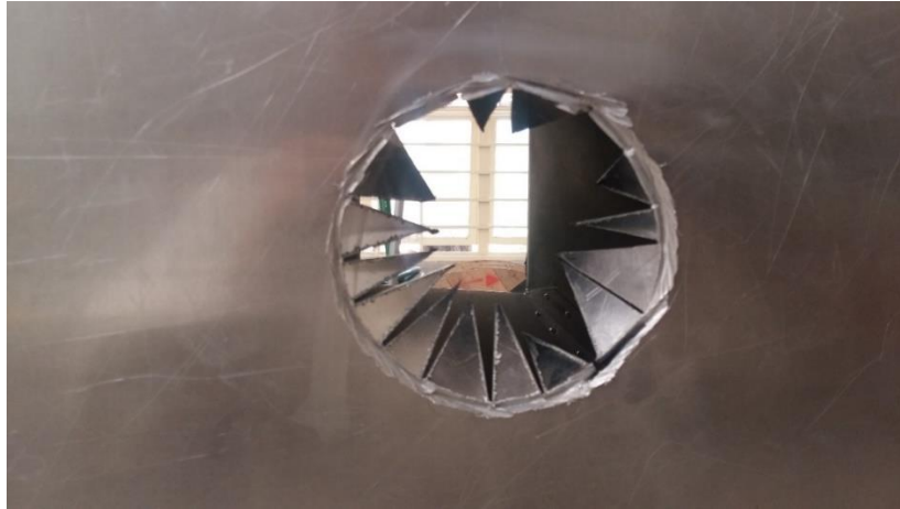
Fig. 90 Corte de la circunferencia medio el uso de esmeril y cortes radiales
