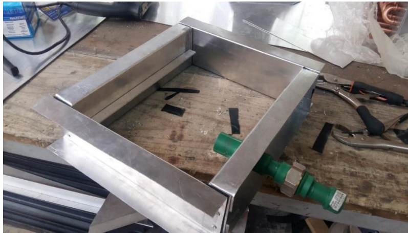
Fig. 157 Ensamble de todos los componentes con un sello de neopreno
