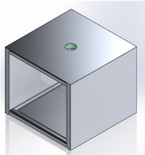
Fig. 31 Modelo 3D de la estructura de la cámara de deshidratado con láminas externas
