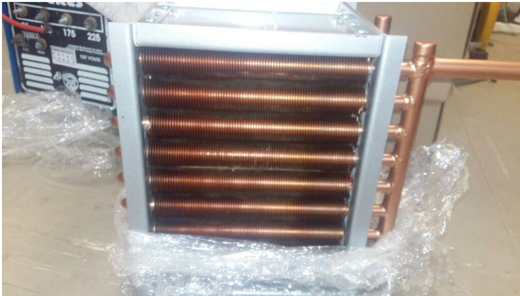
Fig. 74 parte frontal del intercambiador de calor de tubos aletados
