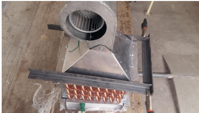
Fig. 168 Tramos de acero para el carrito colocados sobre el intercambiador de calor
