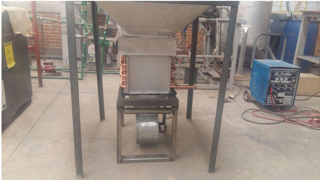
Fig. 152 Ensamble de los difusores a la cámara, al intercambiador de calor y al soplador
