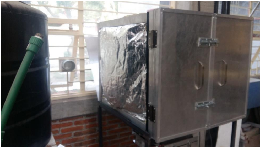
Fig. 104 Aislante colocado en la pared izquierda de la cámara
