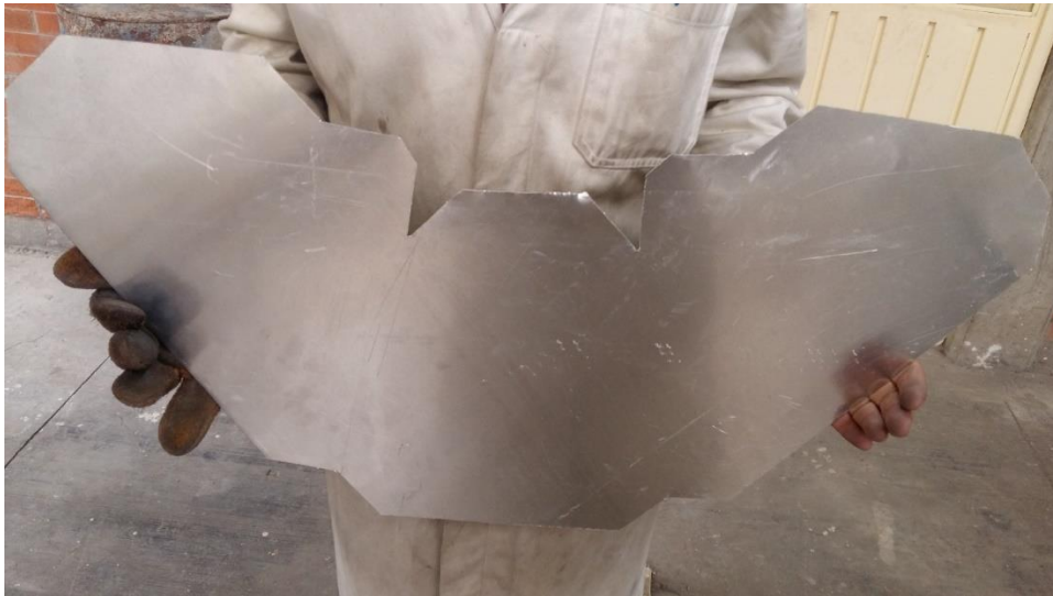
Fig. 135 Lámina cortada con la geometría para doblar
