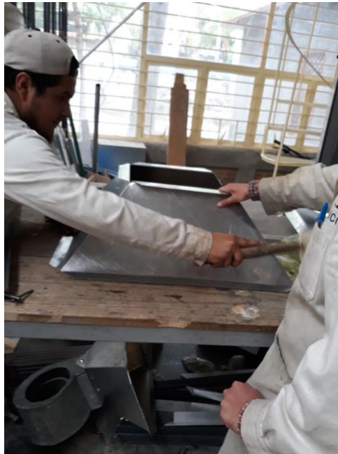
Fig. 150 Lamina doblada junto con las pestañas
