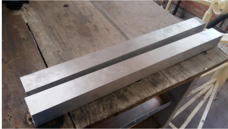
Fig. 79 Tramos de PTR de 50.8 x 50.8 [mm] (2 x 2 [in]) de aluminio cortados
