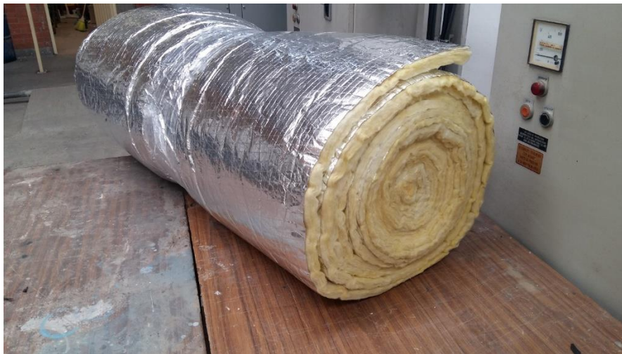
Fig. 98 Lana mineral con recubrimiento de aluminio utilizada como aislante
