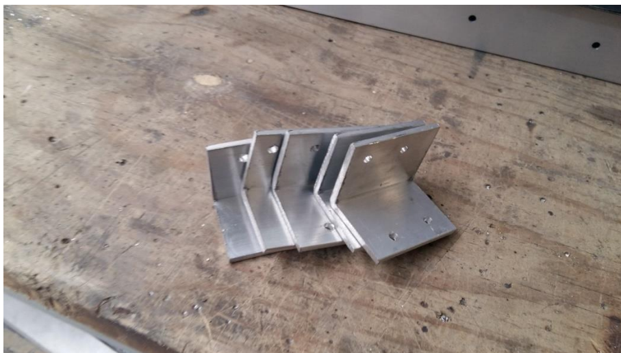
Fig. 80 Ángulos de aluminio cortados y barrenados
