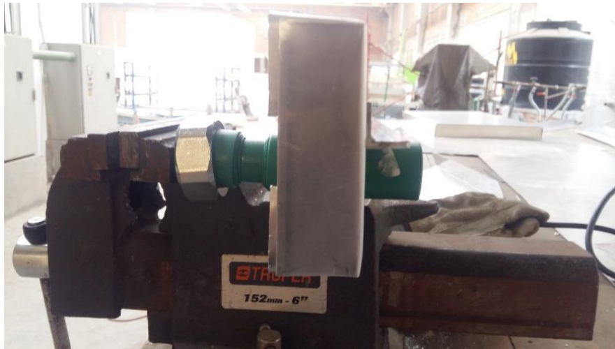
Fig. 156 Vista lateral del ensamble del tubo de desagüe con la lámina doblada para el ducto de limpieza
