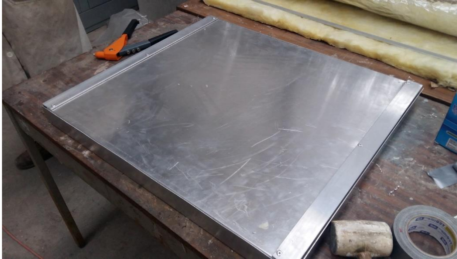
Fig. 107 Piso de la cámara de deshidratador terminado
