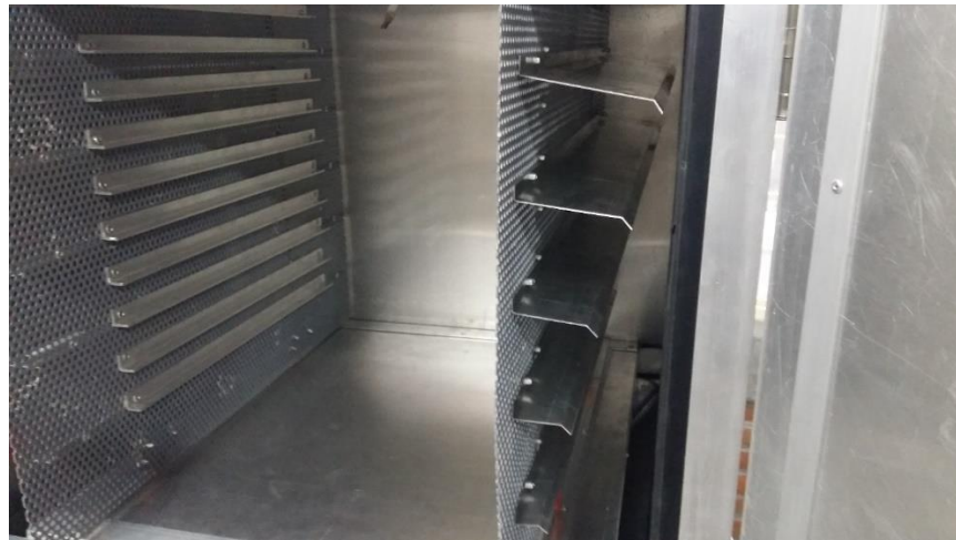
Fig. 118 Vista lateral de los baffles dentro de la cámara de deshidratado
