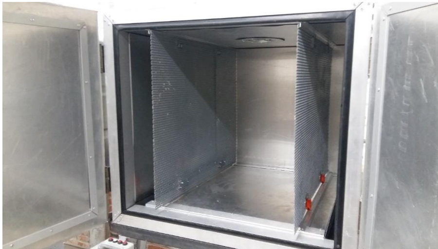
Fig. 112 Ensamble de la lámina perforada y los carriles dentro de la cámara de deshidratado
