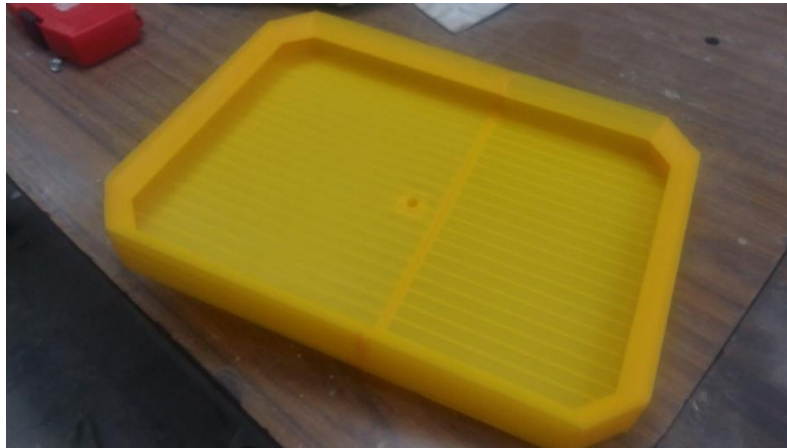
Fig. 165 Piezas unidas por termofusion para completar la tarja
