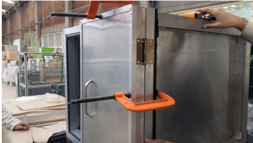
Fig. 100 Bridas para puerta colocadas con remaches
