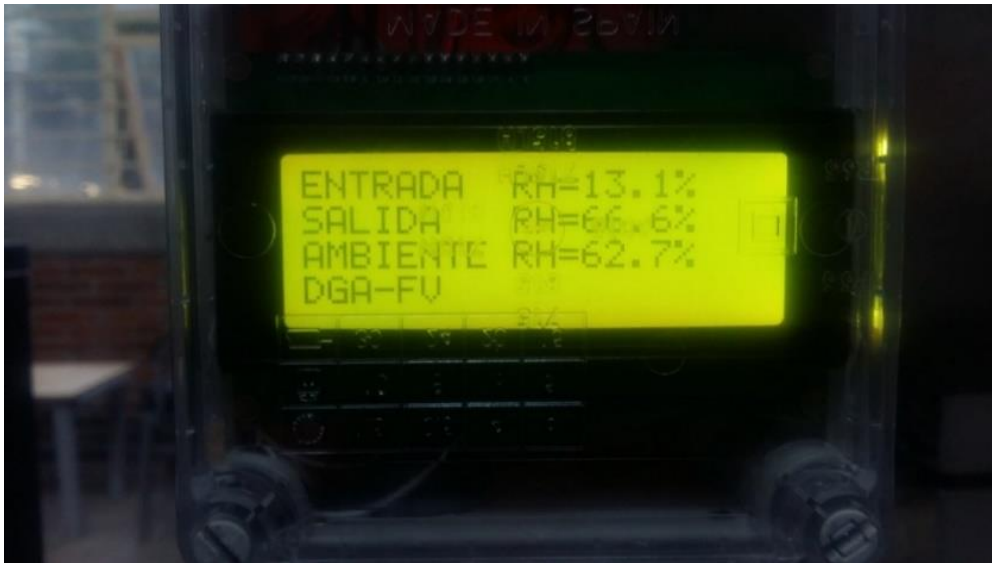
Fig. 177 Panel de control con los valores de humedad que otorgan los sensores
