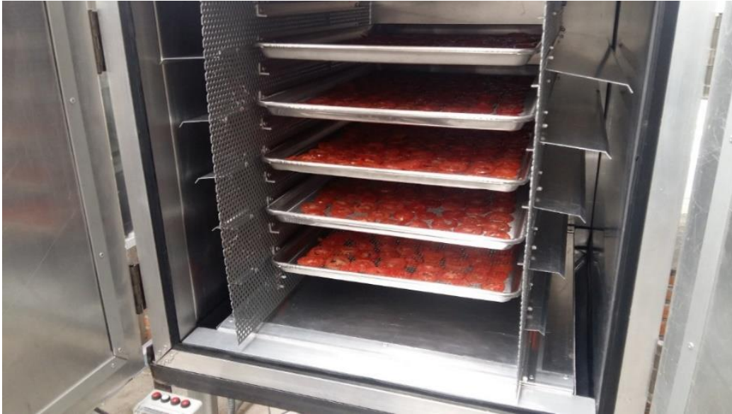
Fig. 192 Charolas colocadas en los espigueros de la cámara de deshidratado
