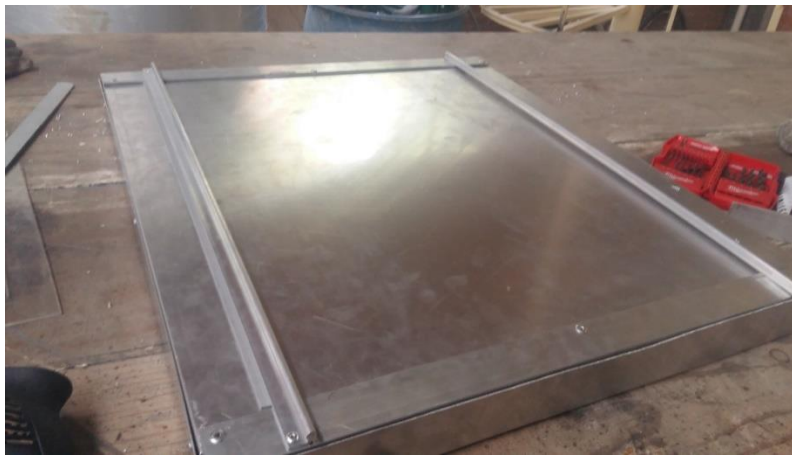
Fig. 108 Piso de la cámara de deshidratado con perfiles de aluminio para carriles de rodamientos
