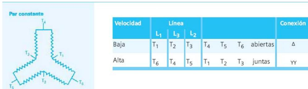
Figura 2: Configuración<sup>5</sup> de conexiones dos velocidades un solo devanado.
