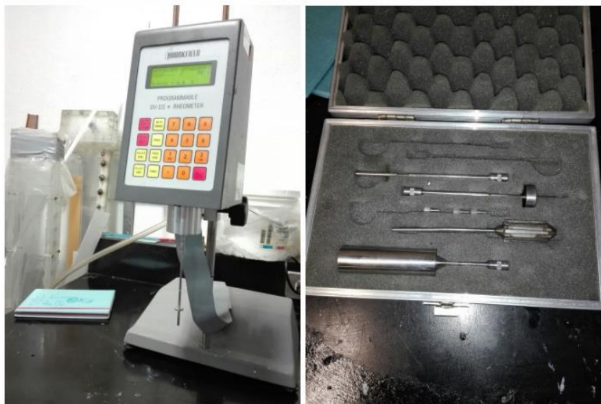
Figura 7.12. Viscosímetro Brookfield y paletas
