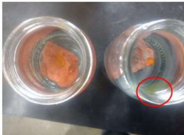
Figura 8.23. Día 15. Vista de planta. Salmuera (izquierda) y nanofluido (derecha). El nanofluido continuó desplazando aceite, la salmuera desprendió gotas muy pequeñas de la roca.
