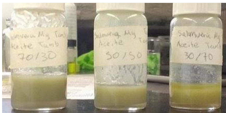
Figura 7.8. Emulsiones en pequeña escala, diferentes cortes agua-aceite y salmuera de magnesio.
