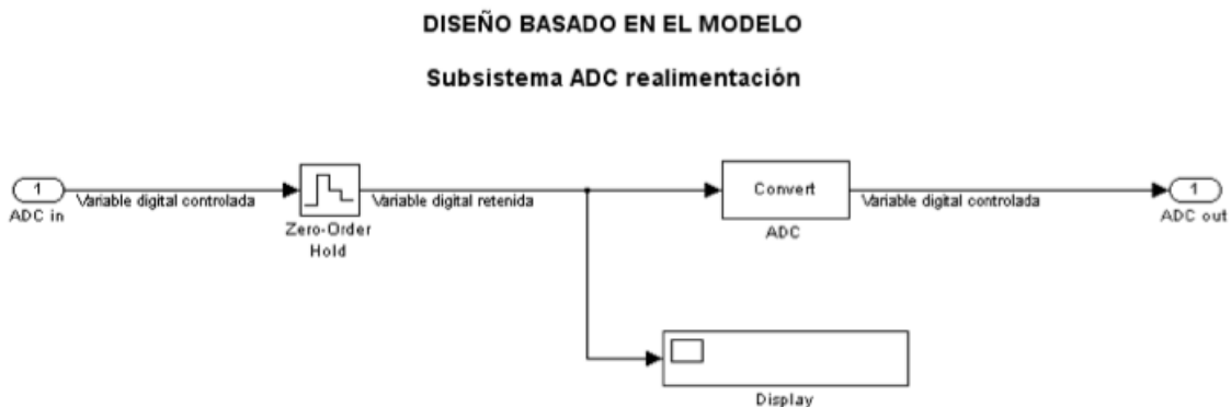
Figura 4.8: Bloque del subsistema conversión ADC de realimentación
