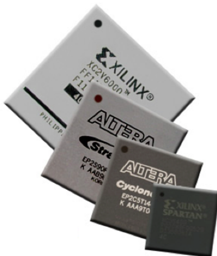
Figura 2.6: FPGA manufacturados por Xilinx y Altera
