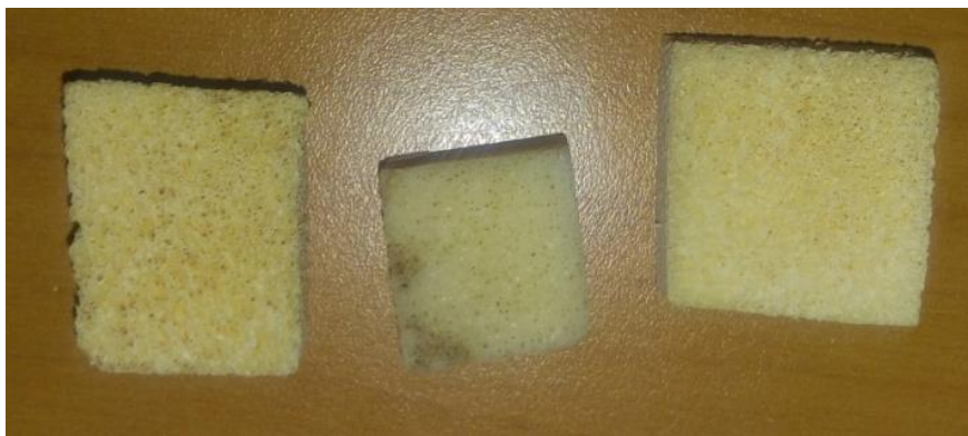
Figura 4.3 Probetas (de izquierda a derecha) de fémur bovino para representar cada dirección (x, y, z).
