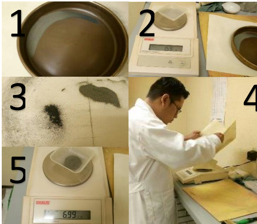
Figura 17. Procedimiento de pesaje de la muestra retenida en el tamiz. 1) tamiz con la muestra. 2) pesaje del recipiente en el que se vierte la muestra para su pesaje. 3) se vierte lo contenido en el tamiz sobre una hoja de papel. 4) se pasa la muestra de la hoja de papel al recipiente. 5) pesaje de la muestra.
