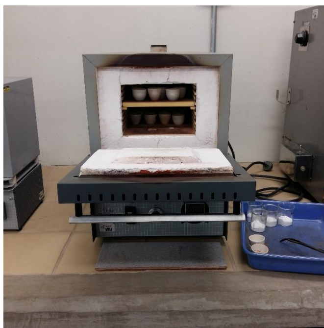
Figura 124. Estufa que se utilizó para el secado de las muestras. . Tomada en el Laboratorio de Fluorescencia de Rayos X, Instituto de Geología.
