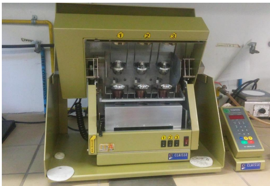
Figura 125. Hornillo de fusión (Mod. Fusión, fluxy claisse). Tomada en el Laboratorio de Fluorescencia de Rayos X, Instituto de Geología.
