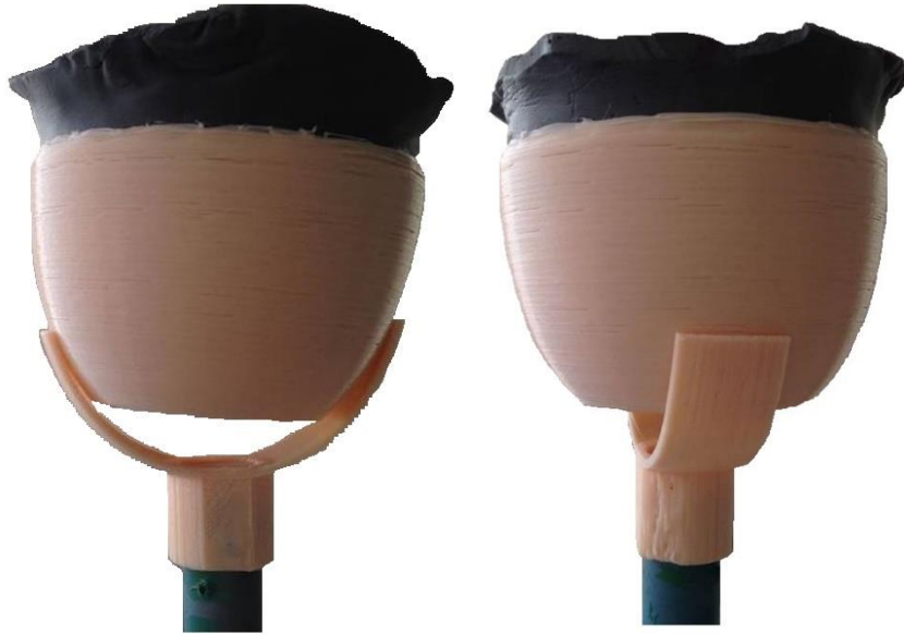
Fotografía 8. Prototipo I de socket. Tomada el 8 de Marzo de 2018.
