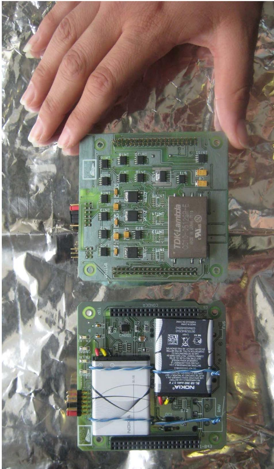
**Figura 5.7** Tarjetas de Electrónica (imagen superior) y Baterías (imagen inferior).
