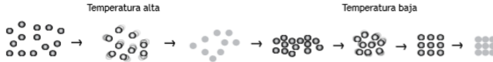
Figura 5. Restructuración molecular de un material férreo al aplicársele un proceso de recocido
