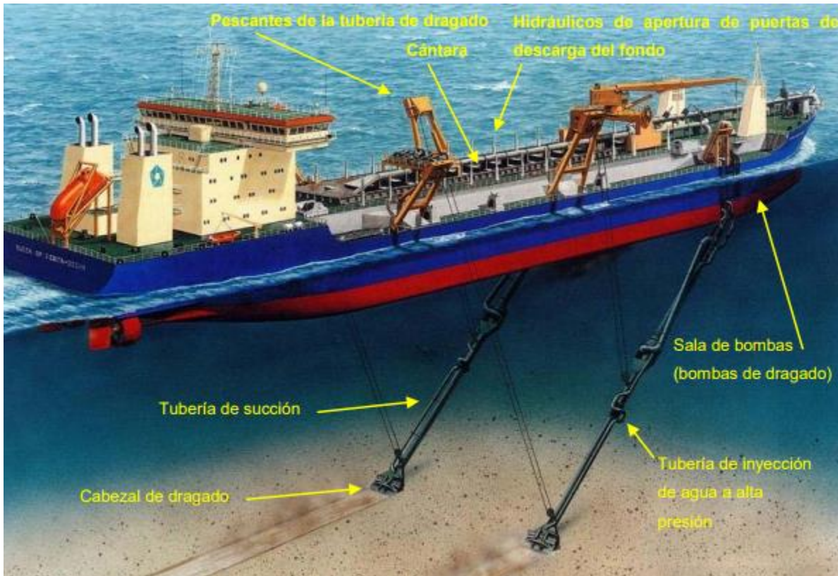
Figura 4. 5. Croquis, draga de succión por arrastre.
