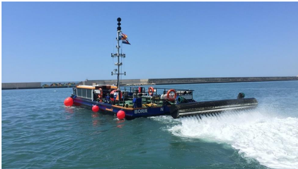
Figura 4. 2. Dragas por inyección de agua. Fuente: DRAVOSA. Dragas de inyección de agua.
