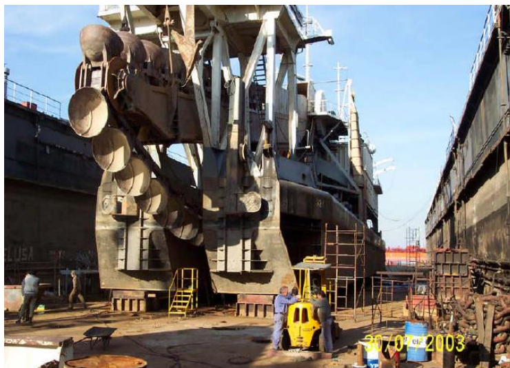
Figura 4. 12. Dragado tipo rosario. Fuente: Dragado en puertos marítimos.
