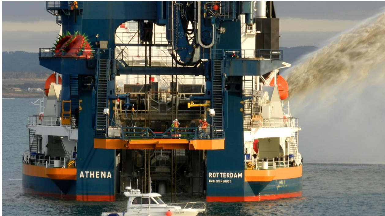
Figura 4. 14. Draga de succión con cortador. Fuente: DRAVOSA. Dragas de cortador
