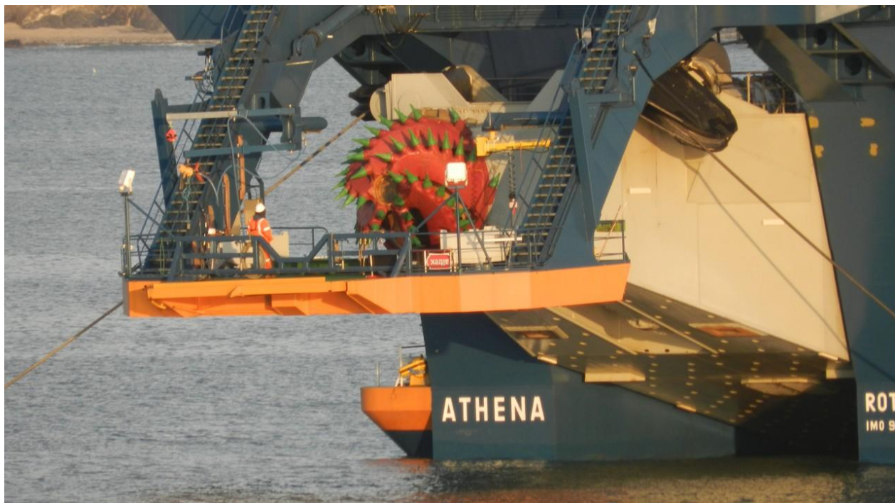
Figura 4. 13. Cortador de la draga. Fuente: DRAVOSA. Dragas de cortador.
