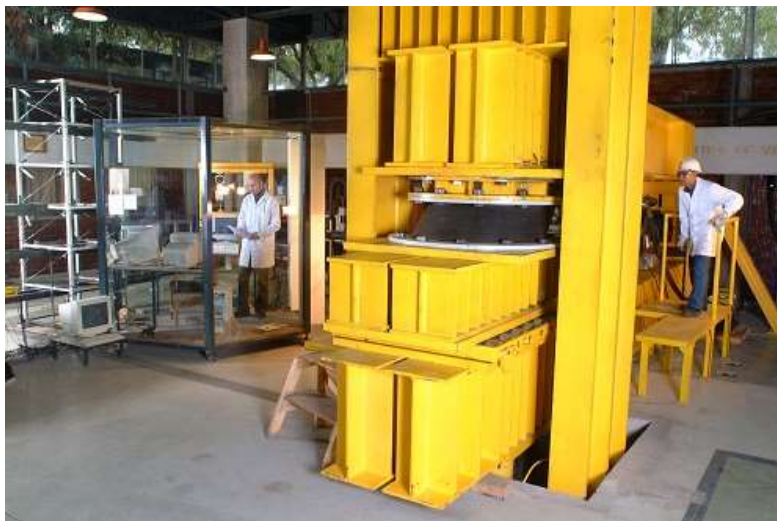
Figura 2.4 Ensayo de un aislador de goma laminada Fuente: Sitio web de Seismic Protection Technologies
