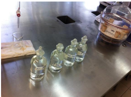
Imagen 4.5. Muestras preparadas con agua de dilución.
