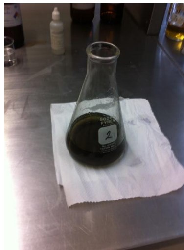
Imagen 4.8. Coloración de la muestra con el almidón.
