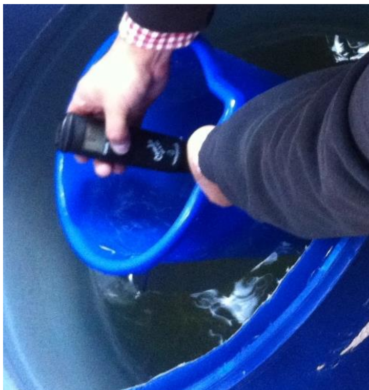
Imagen 3.9. Medición de pH.
