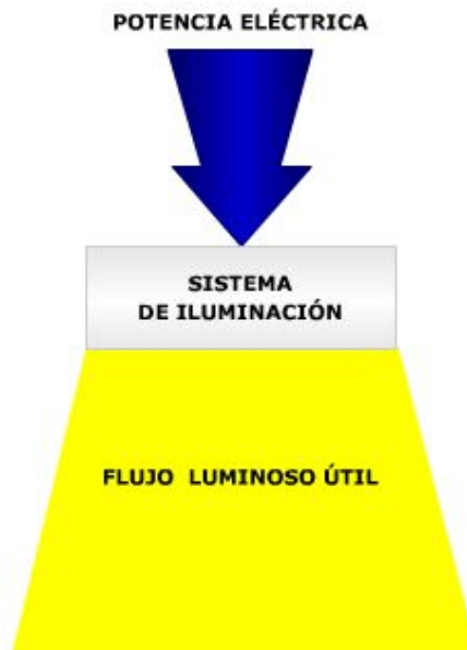
Figura 4.23 Eficacia del sistema de iluminación
