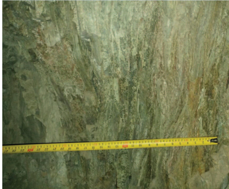
FIGURA 5.14: Fotografía de un pilar en la que se observa un dique riolítico intensamente propilitizado. Se aprecia el flujo bandeado relictos de la riolita.
