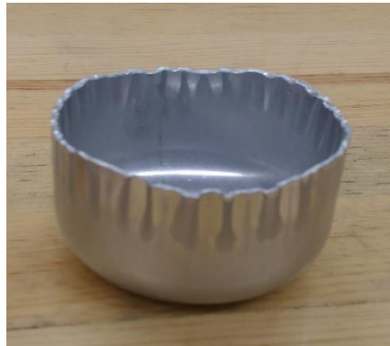
Figura 1.6.- Pieza embutida con arrugas en la pared.
