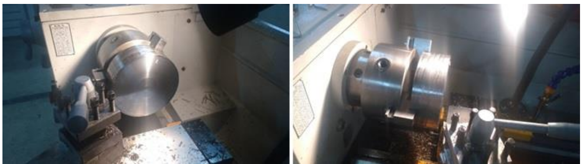
Figura 3.4.- Pieza en bruto de la matriz montada en mordazas de autocentro.
