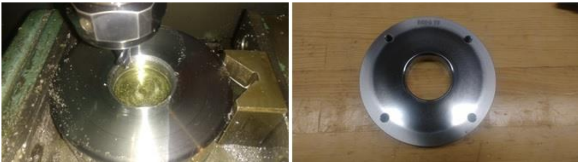
Figura 3.8.- Matriz manufacturada en fresa CNC y terminada.
