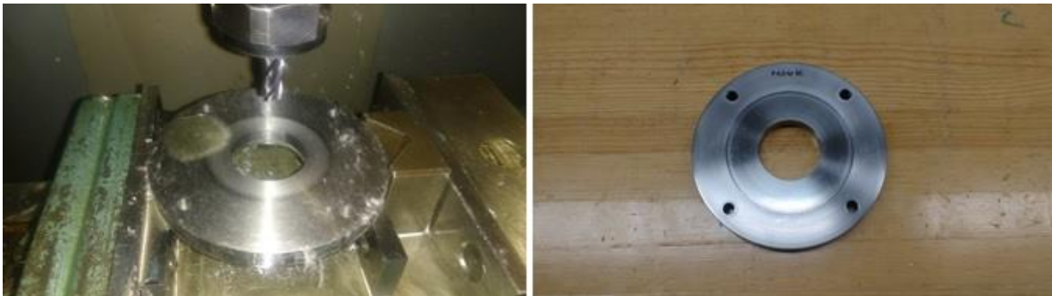
Figura 3.12.- Pisador manufacturado en fresa CNC y terminado.
