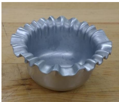
Figura 4.6.- Pieza embutida partiendo de un disco de 100 mm de diámetro.
