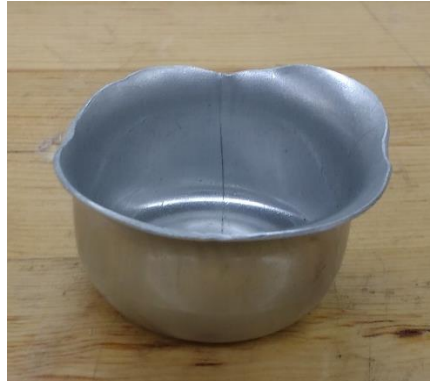
Figura 1.8.- Defectos en la pieza: formación de orejas y mal centrado del disco.
