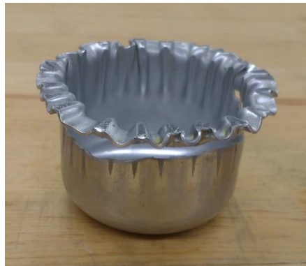
Figura 1.7.- Pieza embutida desgarrada.
