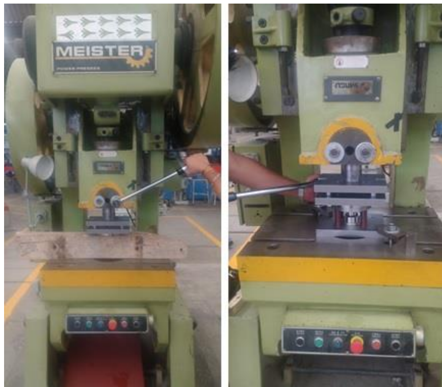
Figura 4.4.- Alineación del troquel de embutido.
