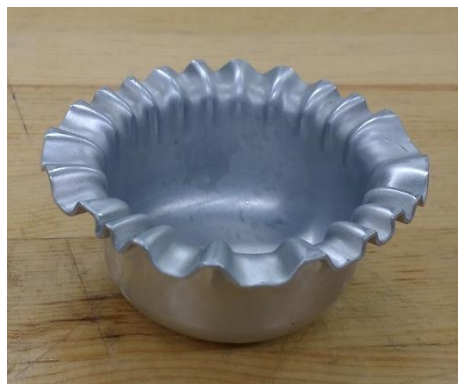
Figura 1.5.- Pieza embutida con arrugas en la pestaña.
