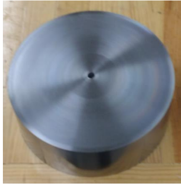
Figura 3.5.- Pieza en bruto de la matriz previamente careada y con un barreno en el centro de 6.35 mm (1/4").
