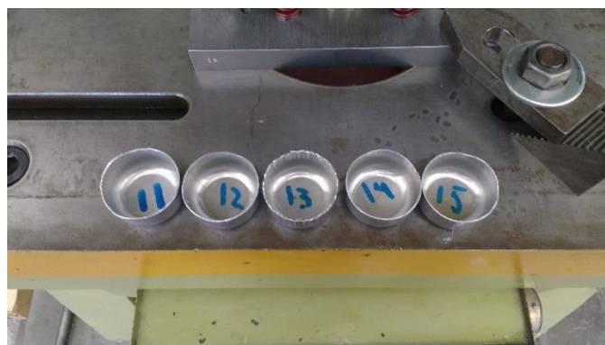
Figura 4.7.- Piezas embutidas partiendo de un disco de 85 mm de diámetro.
