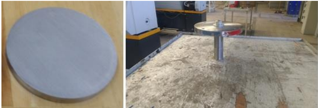
Figura 3.9.- Pieza en bruto del pisador y pieza del pisador en mandril.
