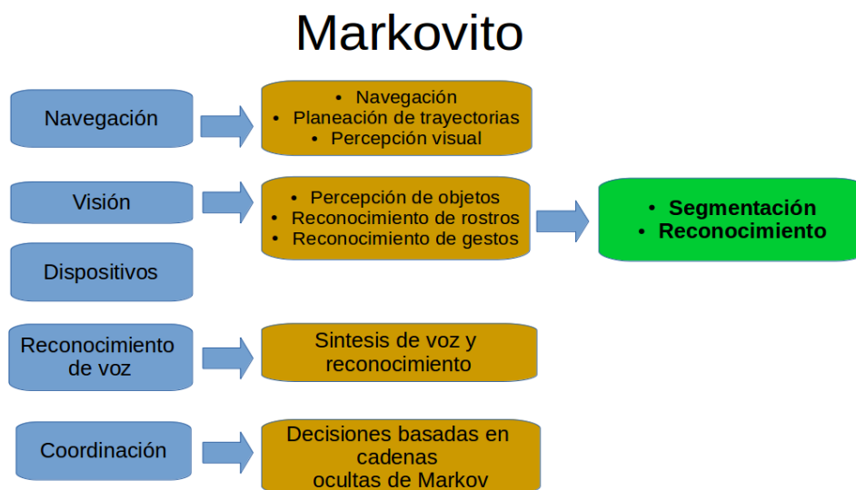
Figura 2.2: Estructura de software del robot Markovito.
