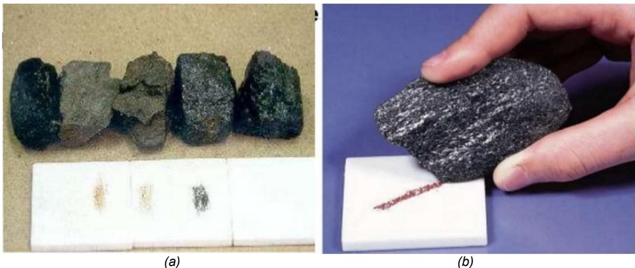
Figura 2.2. Raya. a) Ejemplo de varios minerales junto a sus respectivas rayas, y b) Momento justo cuando se genera la raya. Fuente: es.slideshare.net
