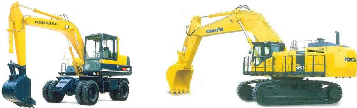
*Figura 6.4. Excavadoras marca Komatsu sobre ruedas (izquierda) y sobre orugas (derecha).*
