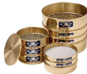
Figura 3.1. Ejemplo de tamiz empleado para realizar la clasificación granulométrica de los suelos. Fuente: [www.macopmine.com](http://www.macopmine.com)
