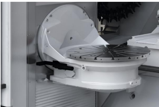
Figura 4.17. Bancada de centro de maquinado y dispositivo de maquinado para la segunda operación.
