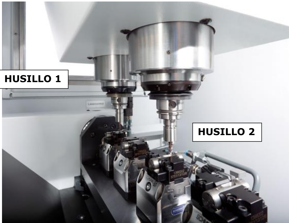
Figura 4.10. Centro de maquinado con dos husillos.
