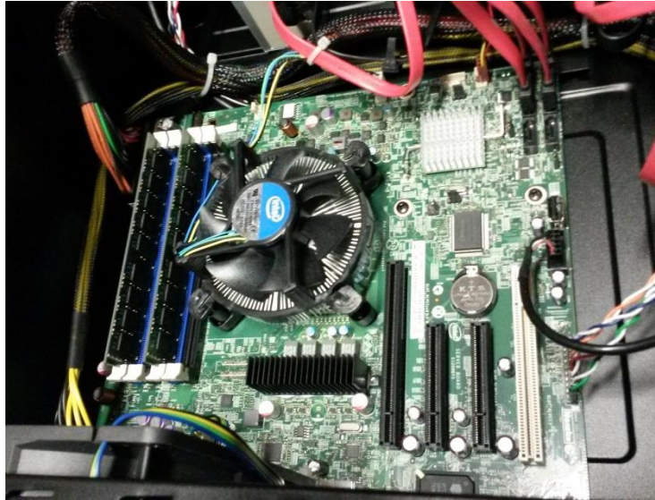
Fotografía 1. Primer ventilador, dedicado solamente al procesador.
