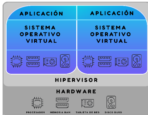
Figura 1. Ejemplifica como un host soporta con su hardware y un programa virtualizador a dos guest y estos a su vez, soportan dos aplicativos independientes.
