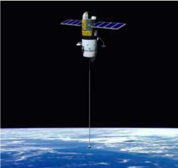
Figura 2.1 Estabilización por gradiente de gravedad
