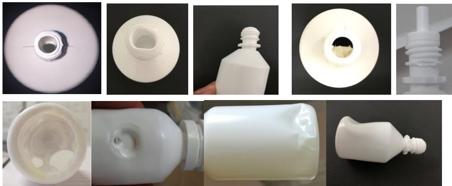
Figura 15. Ejemplos de defectos encontrados en recepción de materiales y en líneas de producción.
