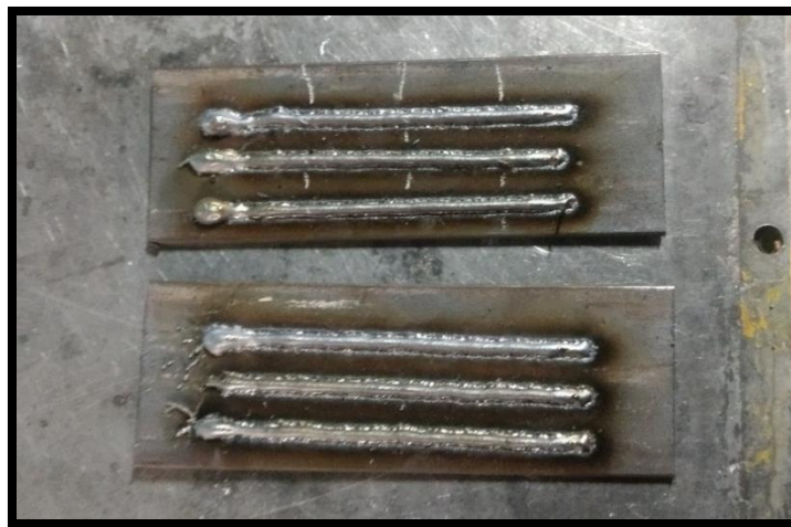
Figura 53. Cordones obtenidos de las primeras pruebas.
