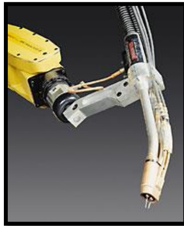
Figura 22. Antorcha del equipo Tandem MIG
