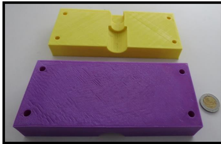
Figura 44. Primer diseño de sujeción en impresión 3D.
