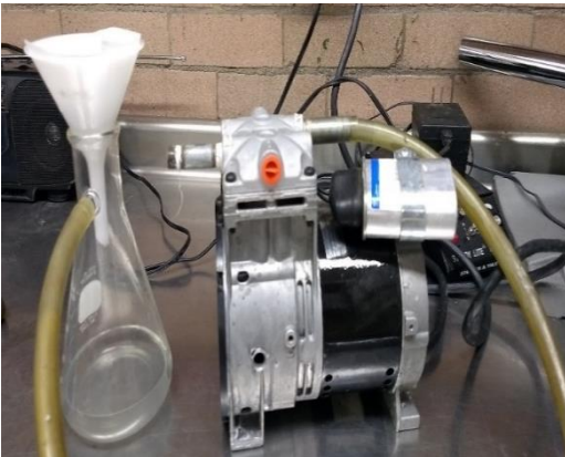
Fotografía 41. Filtración al vacío del cemento de cobre
