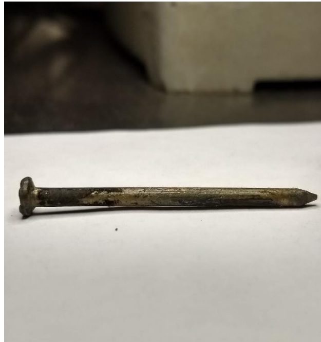
Fotografía 40. Superficie de un clavo de hierro con cobre cementado en ella
