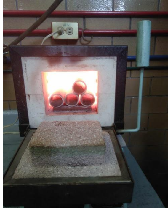
Fotografía 7. Tostación del concentrado de plomo, se aprecia los recipientes cilíndricos de material refractario utilizados
