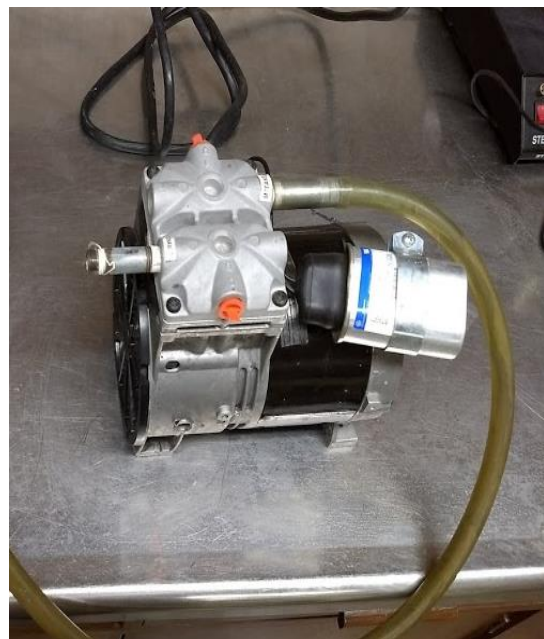
Fotografía 16. Bomba de filtrado al vacío de 1HP
