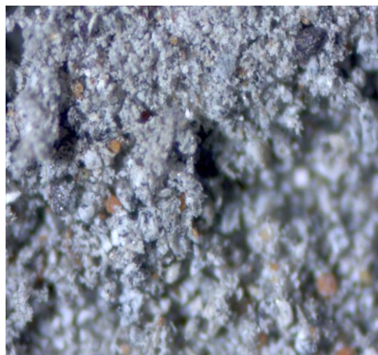
Fotografía 5. Superficie del residuo posterior a la lixiviación con ácido sulfúrico, la presencia de óxidos disminuye radicalmente.
