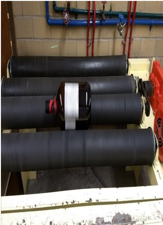
Fotografía 38. Puesta en marcha de la prueba final de lixiviación con ácido sulfúrico
