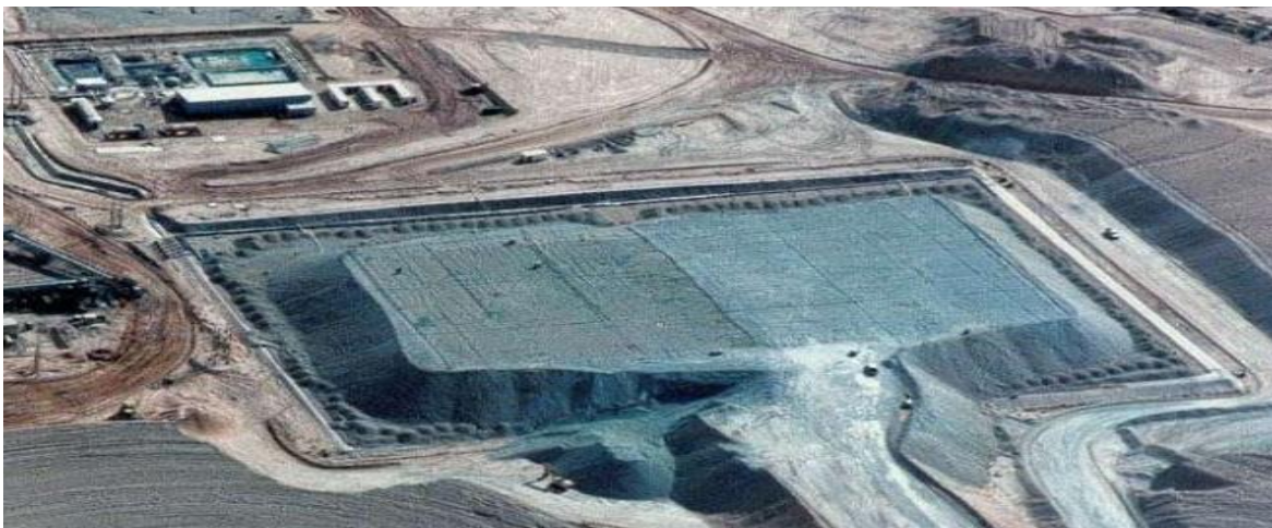
Figura 13. Vista aérea de un sistema de lixiviación de cobre en superficie tipo pila (Aguilar J., 2018)
