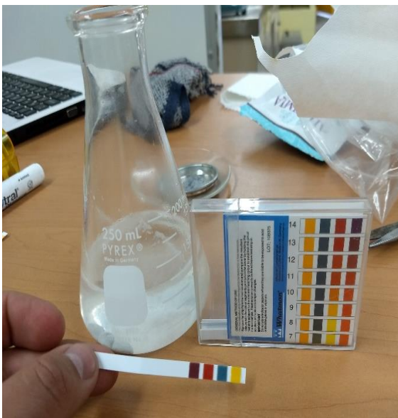
Fotografía 58. Medición de pH 14 del proceso de cementación
