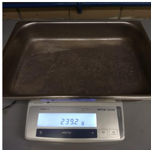
Fotografía 28. Pesado del residuo sólido de la lixiviación ácida de Pb (prueba final)
