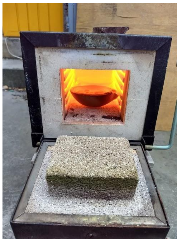
Fotografía 9. Proceso de tostación a 900°C suministrando aire
