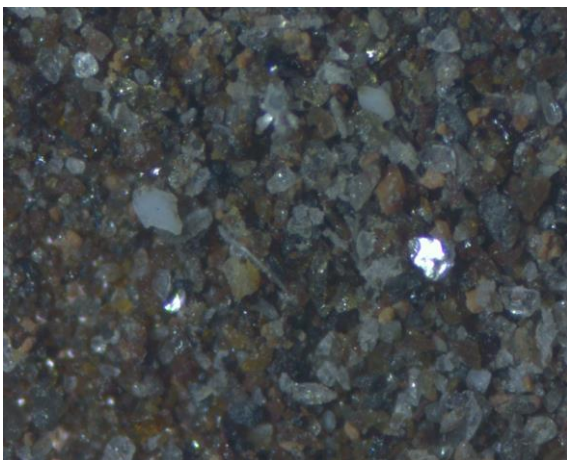
Fotografía 4. Superficie del residuo de la lixiviación ácida de Pb, las partículas plateadas corresponden a plata, los óxidos se distinguen por su color marrón y oscuro.
