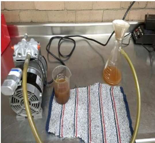
Fotografía 25. Filtrado al vacío de la solución de lixiviación
