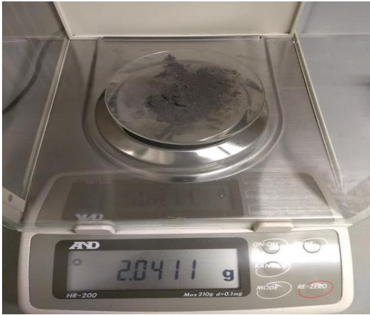
Fotografía 26. Pesado del residuo sólido de la lixiviación ácida (prueba preliminar)
