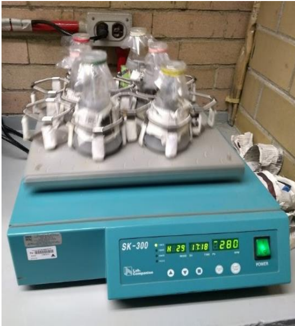
Fotografía 53. Puesta en marcha de la lixiviación dinámica de oro y plata con NaCN
