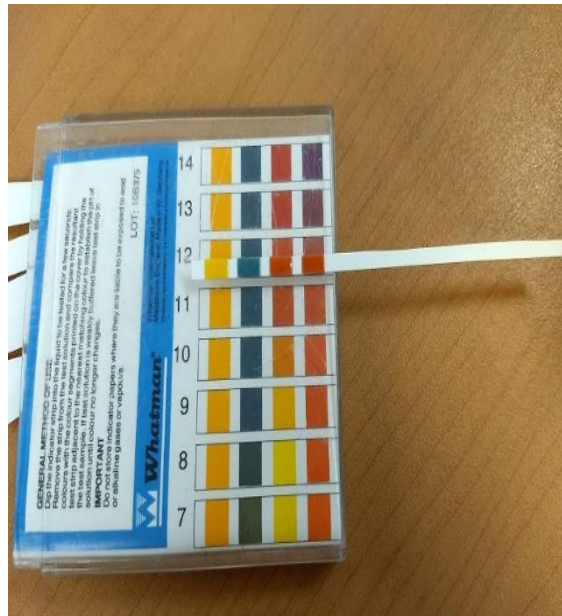
Fotografía 50. Medición del pH 11 de las soluciones de lixiviación
