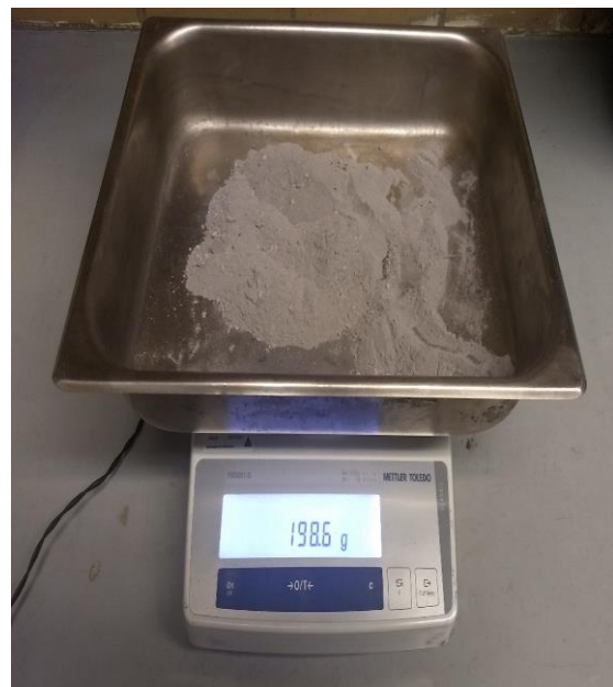
Fotografía 35. Pesado del residuo sólido de la lixiviación de cobre con ácido sulfúrico
