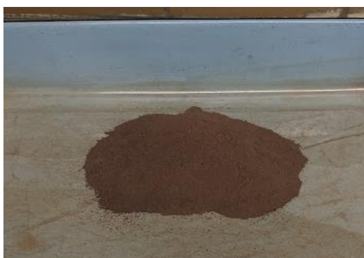
Fotografía 10. Concentrado de Pb posterior a la tostación
