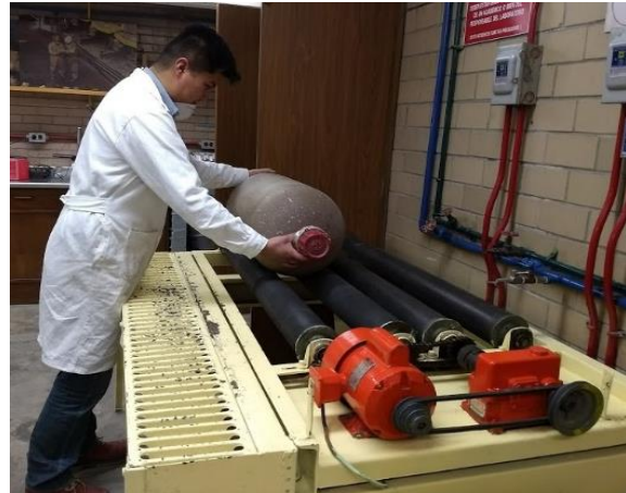
Fotografía 27. Puesta en marcha de la prueba final de lixiviación
