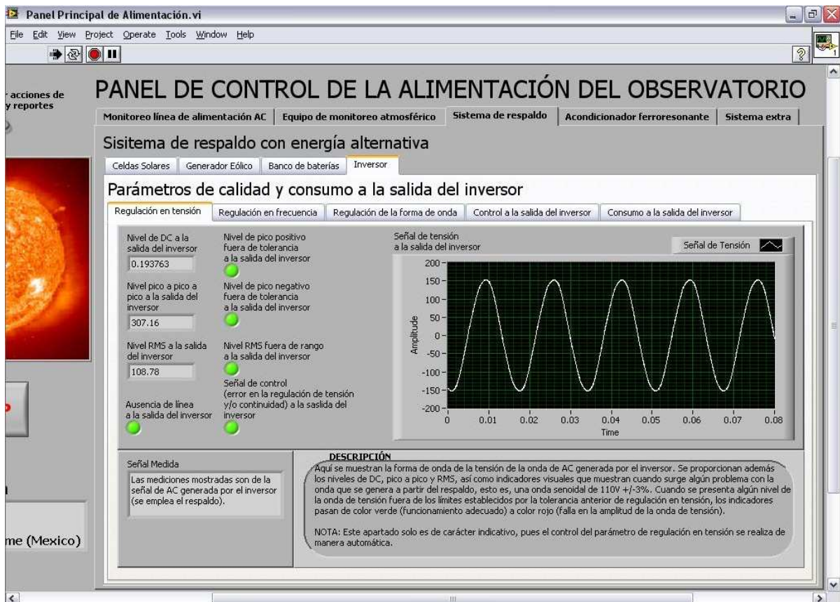
Figura 6.7 Panel frontal del subVI Regulación en tensión y continuidad (salida inversor) operando en el programa principal.
