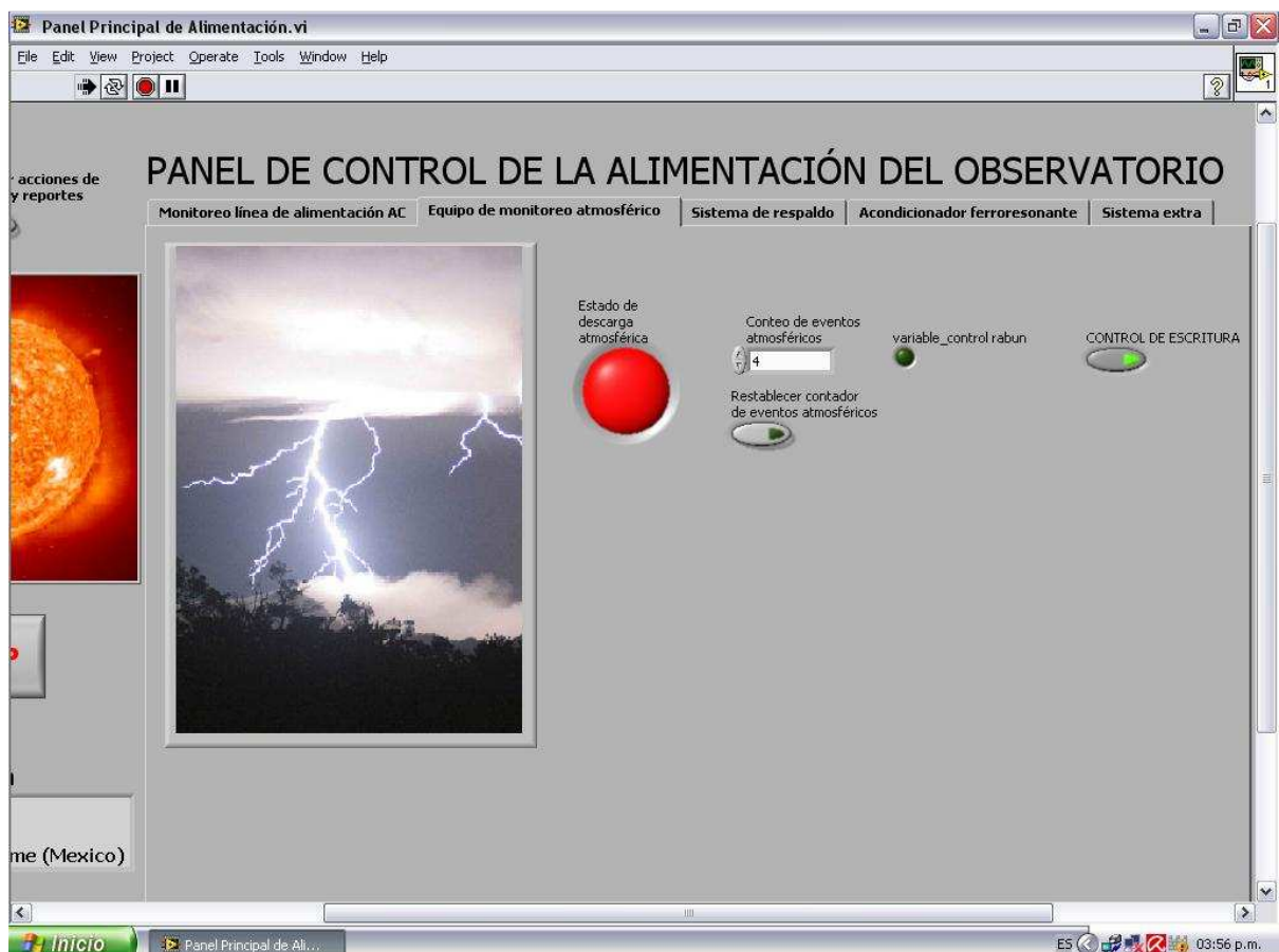
Figura 6.5 Diagrama a bloques y Panel frontal (durante una descarga detectada) del VI Monitorización de descargas atmosféricas , empleado como subVI dentro del programa principal Panel Principal de Alimentación .
