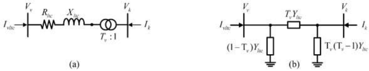
Figura 3.5 Representación simplificada del modelo del transformador OLTC para flujos de potencia; (a) Tap en posición nominal, (b) Tap en posición fuera del nominal
