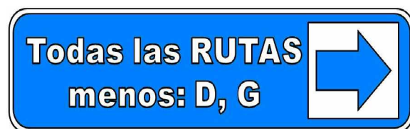
Figura V.2.3-5. Señalamiento informativo en dirección a todas las rutas menos la Ruta D, y la Ruta G de transporte público semi-masivo, sin necesidad de especificar si se trata de escaleras fijas o eléctricas por existir la opción de las dos.
