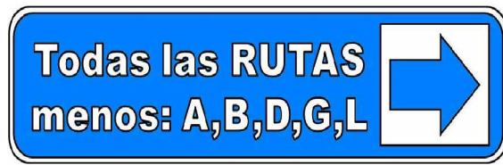
Figura V.2.3-7. Señalamiento informativo en dirección a todas las rutas menos la Ruta A, la Ruta B, la Ruta D, la Ruta G y la Ruta L de transporte público semi-masivo, sin necesidad de especificar si se trata de escaleras fijas o eléctricas por sólo presentarse las primeras.
