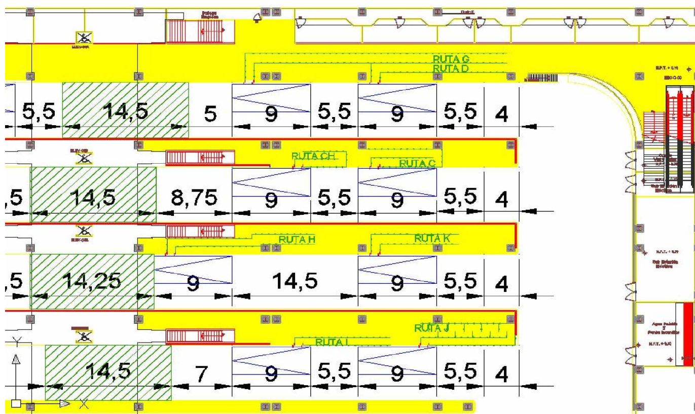
Figura IV.3.2.2-1. Disposición final de puntos de ascenso en el paradero oriente ala norte.
