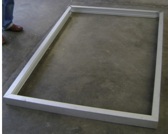
Figura 7. Marco de Aluminio de 3" para la caja del colector.
