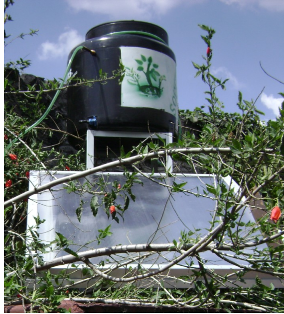
Figura 12. Base del colector a 19 grados.
