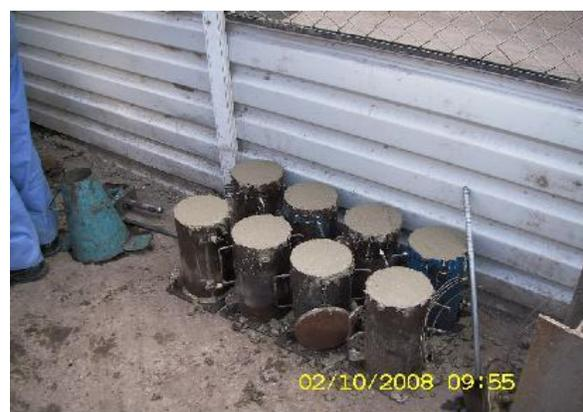
Cilindros para pruebas de compresión
