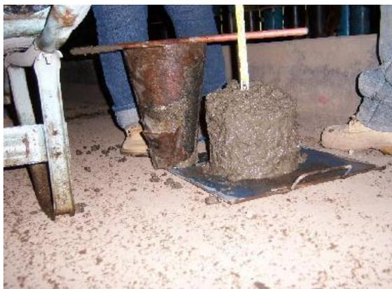
Prueba de revenimiento del concreto.
