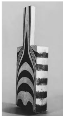
Figura 1.13: Modelo material en cera para visualización de flujo de extrusión (Totten, 2006).
