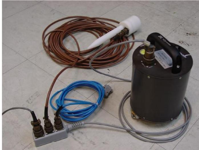
*Figura 17. Sismómetro triaxial Guralp 6TD.*
