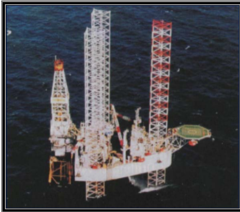
Fig. A13.5 Plataforma tipo Autoelevable
