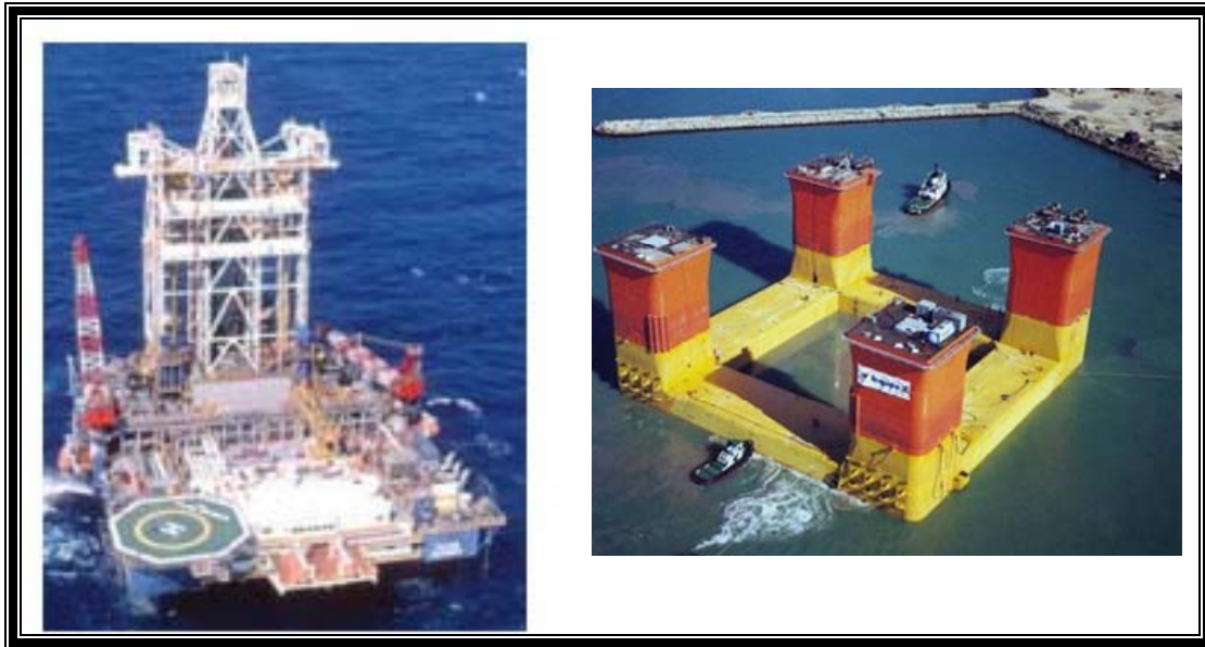
Fig. A13.7 Plataformas semisumergibles
