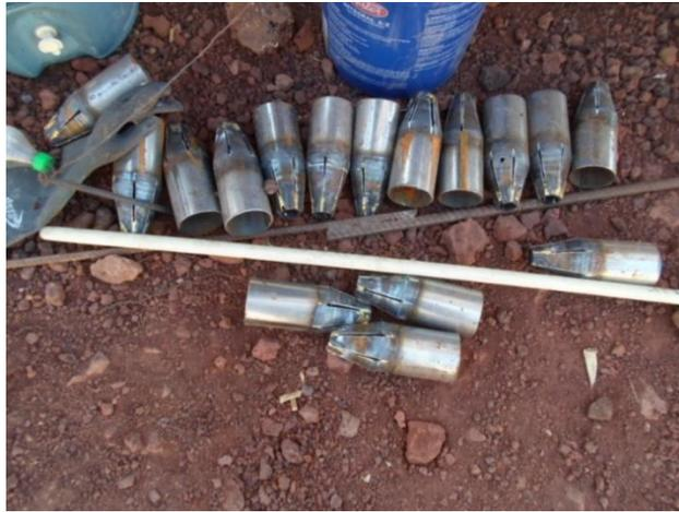
*Fotografía 3. Puntas ojivales usadas en la fabricación de anclas.*
